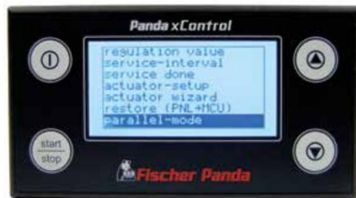
Parallelmodus mit jedem Generator der xControl-Serie möglich
