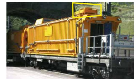
Separate Montage des Kühlers auf dem Dach des Waggons
